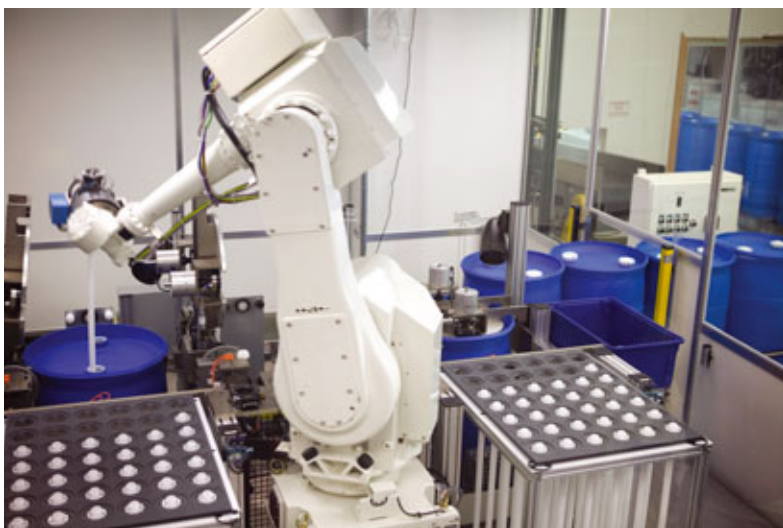
Entegris のクラス 1000 クリーンルームでは、自動化された組 および試験手順を活用することによりドラムの清浄度を確保しています。
