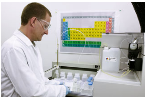
マス質量分析計による金属の分子汚染分析。
