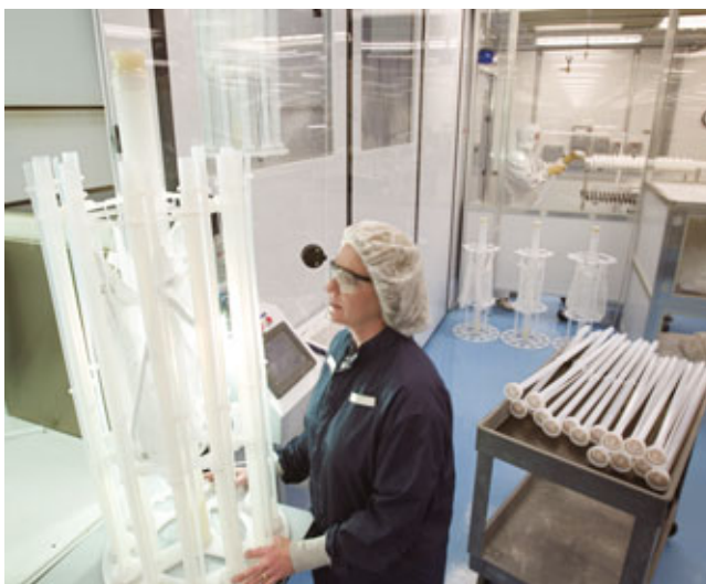
Entegris は事前にドラムを清掃してからクラス 100 の自動クリーニングシステムに挿入します。
