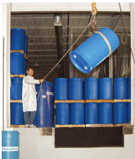
Entegris は作業現場での落下試験を定期的実施して、製品の信頼性と安全性を確保しています。
