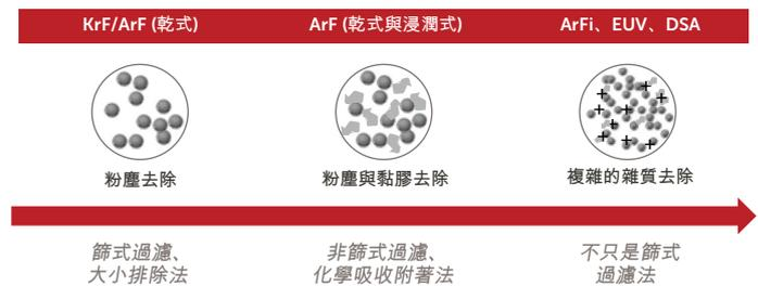
圖 1. 各種瑕疵攔截機制的圖解說明。
