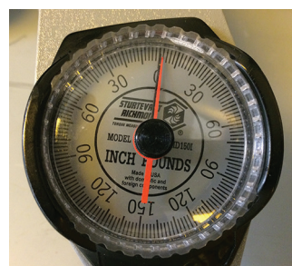
図 4. 正確にゼロ調整したトルクレンチ
