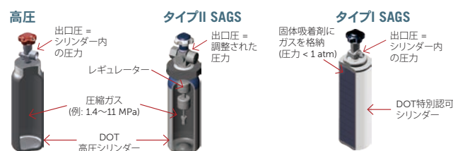
図 2: 高压シリンダーや SAGS タイプ II シリンダーと比べて、SAGS タイプ I シリンダーは負圧でガスを保管および供給するため、危険なガス漏れが起こる可能性が低い
