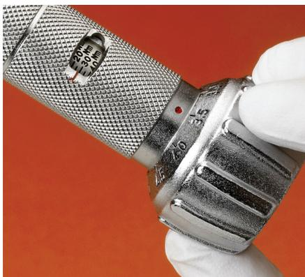
設定が完了したら、レンチの下部にあるレバーを時計回りに回転させ、ロックしてください。
