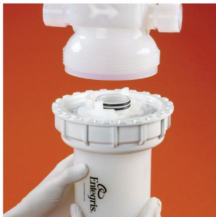
5. E-FKM O-リングを使用する場合は、トルク値を45 N・mに設定してください。その他のO-リングの場合は、28.5 N・mに設定してください。
