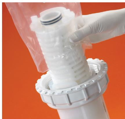
3. 梱包袋の開口部を使って、ケムロックキーにある 2 つのタブに指を当て、カートリッジを時計回りに 1/4 回転させてカートリッジをボウルに固定します。
