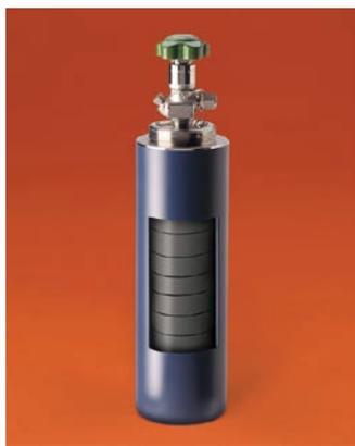
SDS シリンダーでは、ガス分子を吸着し、低圧 (常圧以下) のガス状態を作り出すナノポーラス BrightBlack カーボンパックの内部にガスを充填することで、標準的な高圧力のシリンダーから圧力を取り除いています。この技術と手法により危険性が高いガスが漏れる事故を解消します。
